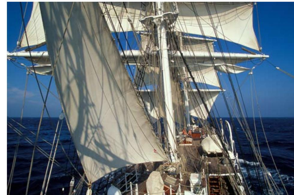
**Le gréement de quatre-mâts barque** De l'avant vers l'arrière se succèdent le mât de misaine, le grand-mât, le grand-mât arrière et l'artimon. Caractéristique du gréement en barque, le mât d'artimon porte une voile aurique surmontée d'un flèche. Les quatre-mâts carrés – rares – portaient sur leur artimon le même étagement de voiles que sur leurs autres mâts.
